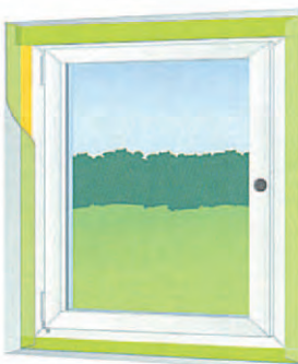
Bild 3: Fensterdichtband umschlagen und den Selbstklebestreifen an den Fensterrahmen ankleben.
