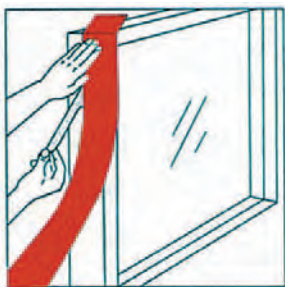
Bild 1: Befestigungsstreifen der vlies-kaschierten Seite sorgfältig auf dem Fensterrücken andrücken.
