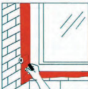
Bild 3: Schutzfolie der Butylseite abziehen, das Band auf den Untergrund kleben und sorgfältig andrücken.
