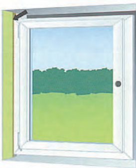
Bild 1: Butylstreifen des Fensterdichtbandes an die Laibung ankleben.
